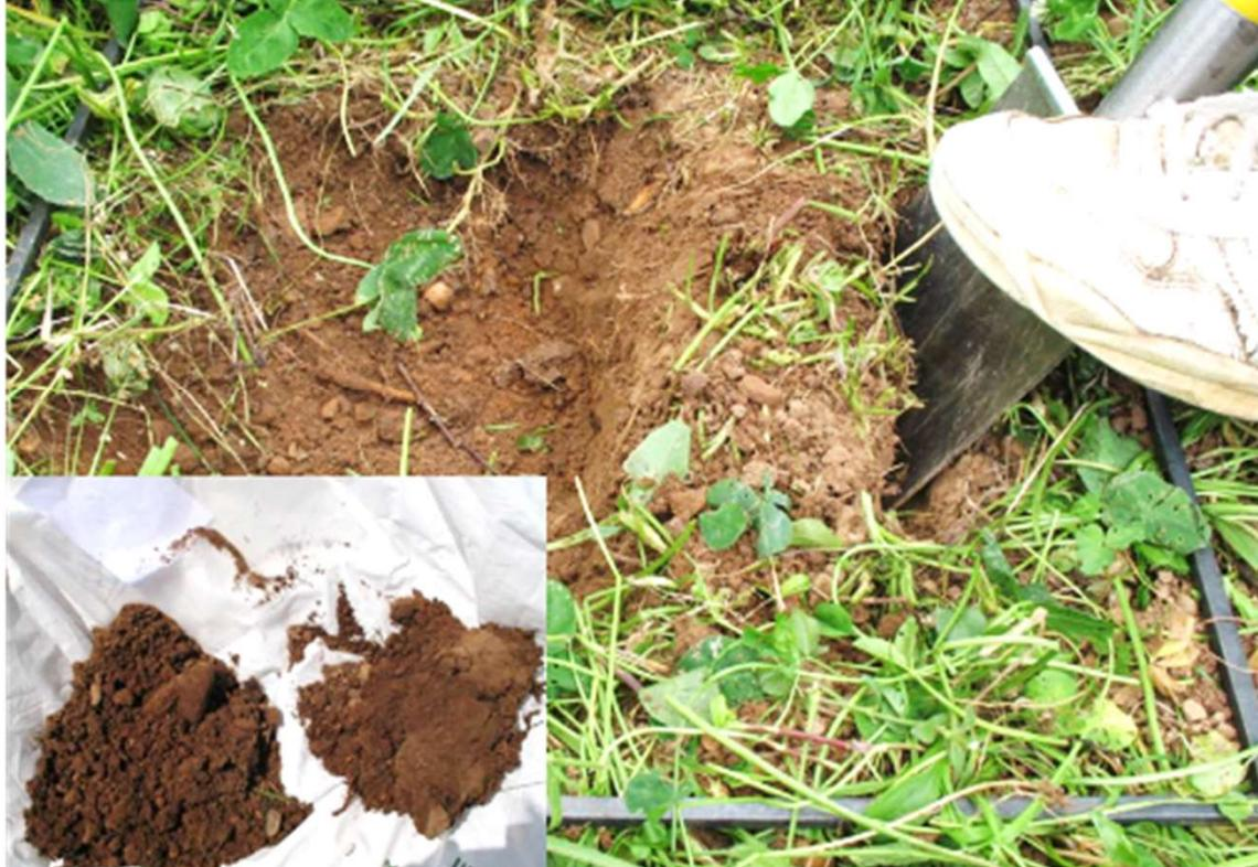
mesure de l'écoulement de l'eau : test de Beerkan
