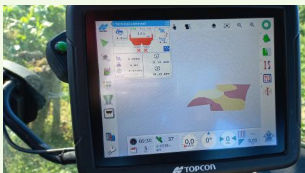
Console embarquée, avec un exemple de carte de préconisation (plus d'engrais sur les zones claires).
