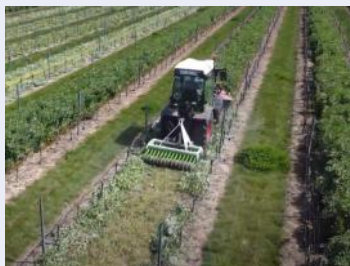
Le couvert est déporté sous le rang au moment de la fauche.
